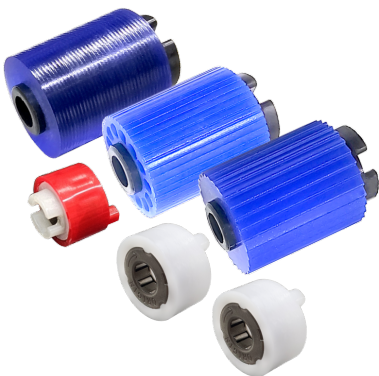
[Sr-C04F] 卡式送料器全套 适用于单个纸盒的完整送纸组件。主送纸器采用锯齿状边缘有效拉纸，副送纸器采用带孔滚轮防止卡纸，向送纸器采用耐用的聚氨酯滚轮，经久耐用。
