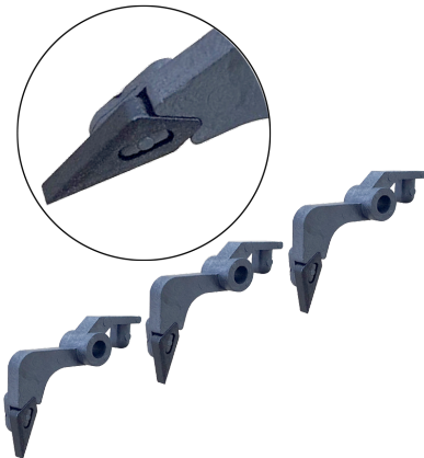
[Sf-006] 夹具压辊手指 通过将指尖制成硬质材料，只需更换一次指尖即可半永久性使用的改进产品。
