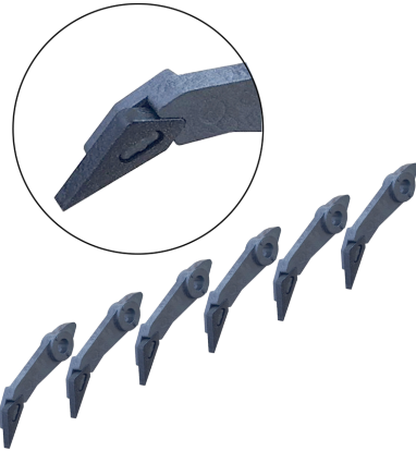
[Xf-004] 정착부 히터롤러 핑거 핑거의 구조각을 바꾸어 종이 걸림이 없도록 만든 제품. 핑거 끝날을 단단한 재질로 만들어 오래 사용 가능함
